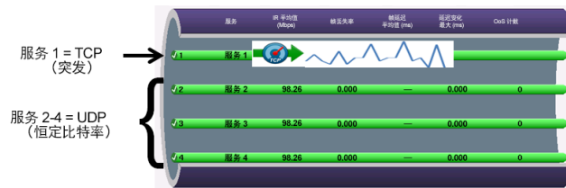
图 19. 包含集成 TrueSpeed 服务的 Y.1564 性能测试阶段
