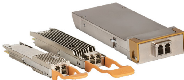
图 5 - DCO QSFP-DD、OSFP、CFP2 的可插拔外形规格 – 由 Acacia 4 提供
