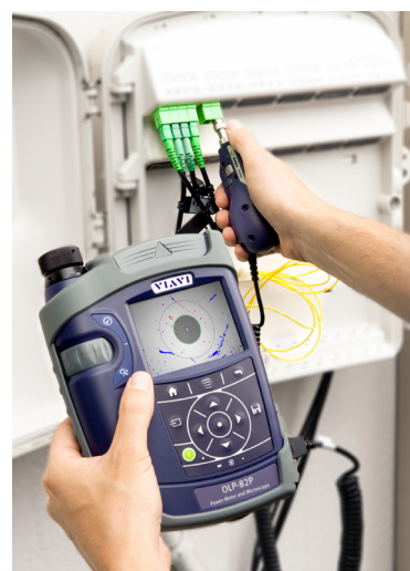
集成了功率计和跳线显微镜的 SmartClass Fiber 系统
