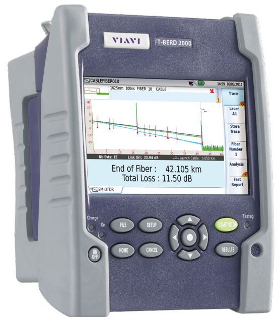
VIAVI MTS-2000 可以集成 VFL 以检测弯曲或断裂
